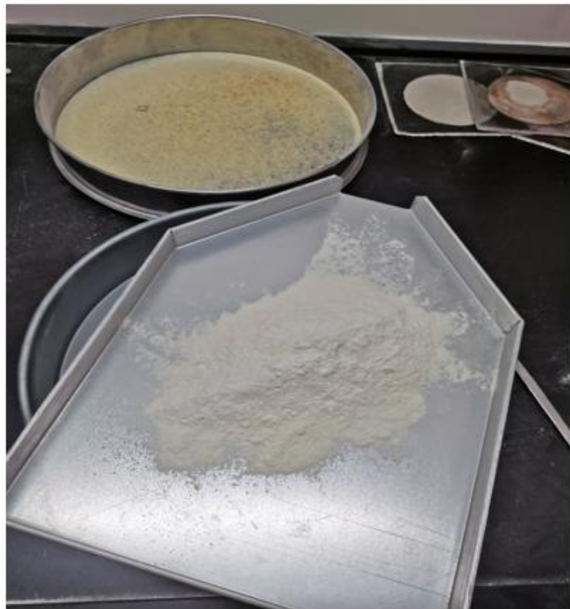
(10)天冬粉 筛上物——圆筛里 天冬粉 筛下物——金属框里
